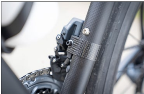
Leichtbau, Teil 1: Sogar die Umwerferschelle ist hier aus Carbon gefertigt.
